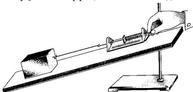
2. Определите с помощью динамометра вес бруска.
